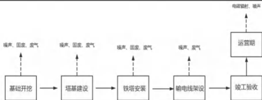
图 2-3 输电线路施工工艺时序图
